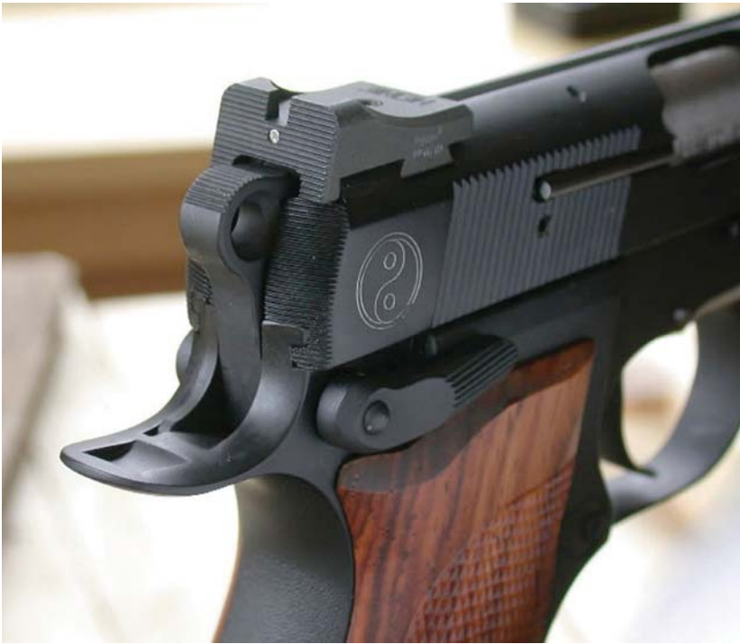
Детљал „кастомизованог“ НР-а из „Morris Custom Pistols“: штићник шаке на реју усадника
