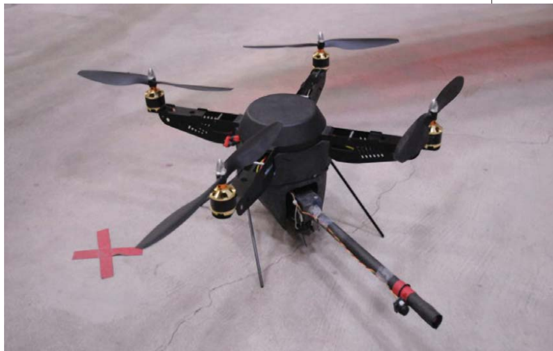
Модел квадроскоп са пинбол оружјем, које испушта обојене куглице на циљевике
